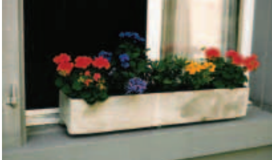
Bacs à fleurs en amiante-ciment
